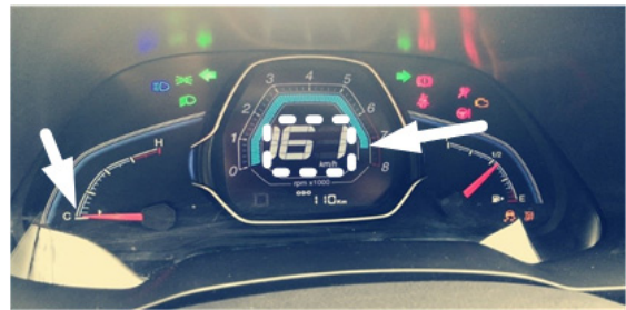
图4 汽车仪表盘显示数据篡改实验结果
